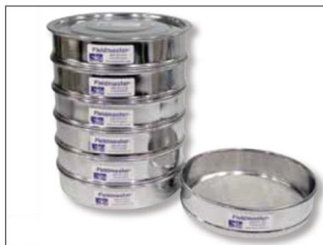
Foto. 12. Set de tamices utilizado para determinación la composición granulométrica del sedimento de Chañaral norte
