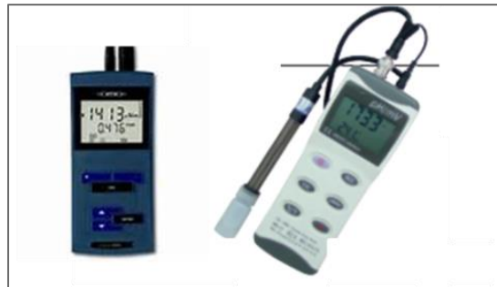
Foto 11. Conductivímetro y phmetro utilizados para medición de temperatura, salinidad y pH.
