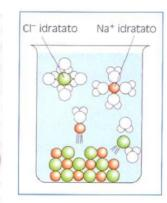
Nella dissoluzione del NaCl in acqua gli ioni Na<sup>+</sup> e Cl<sup>-</sup> si dicono idratati.
