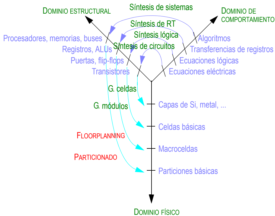
Figura 1.8.- Procesos en el flujo de diseño top-down.
