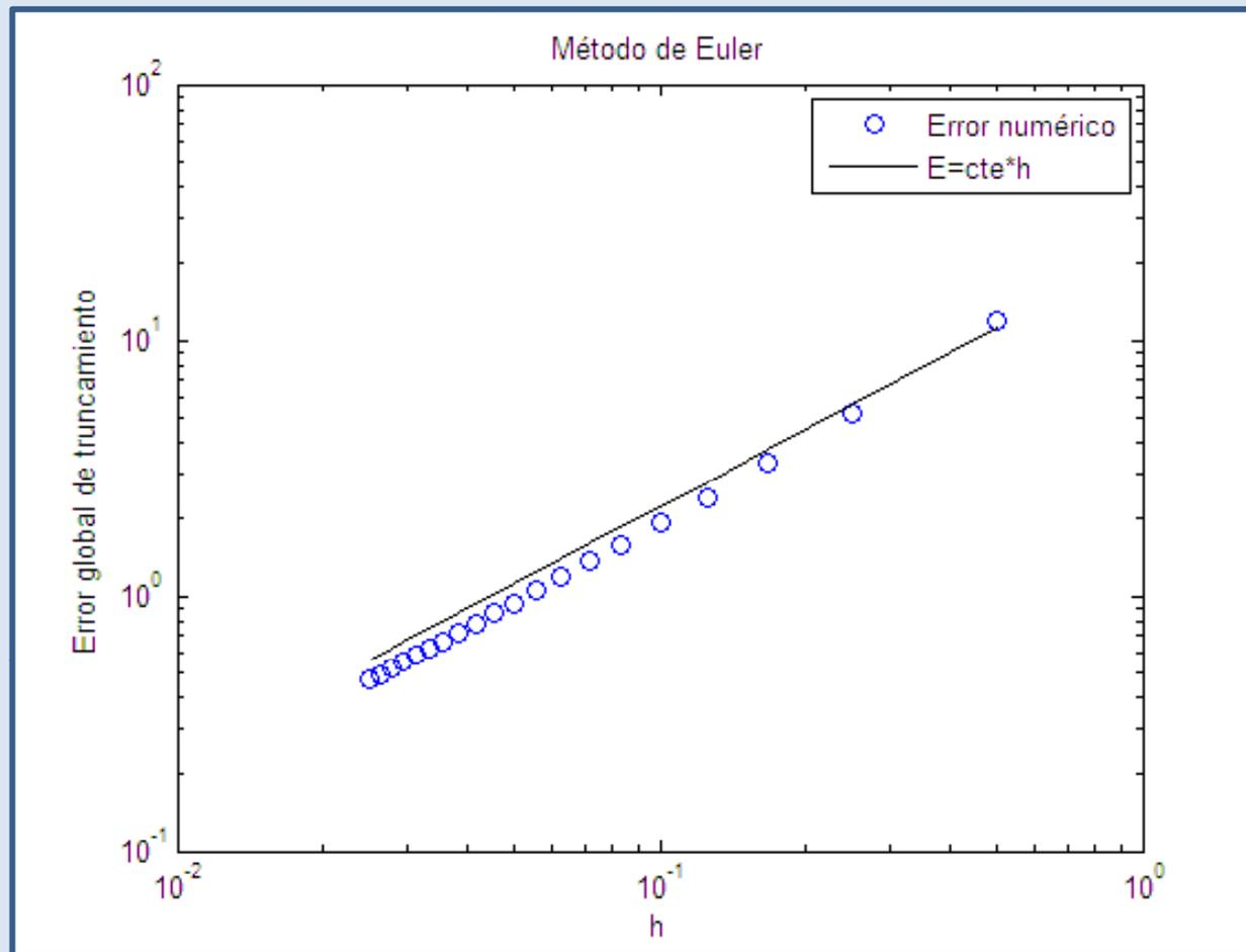
El máximo error de truncamiento del método de Euler es proporcional al tamaño del paso  $h$ .
