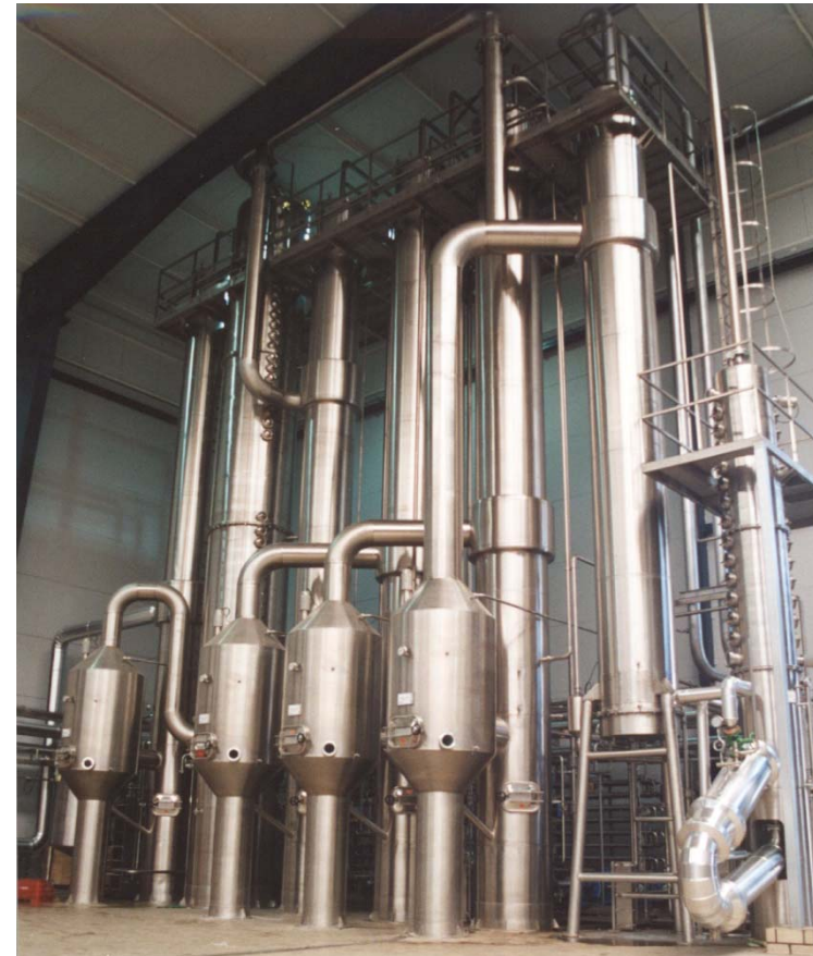
Evaporador múltiple efecto con columna depuradora para subproductos oleícolas (alpechines) y purines
